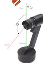
Специальная сканирующая камера, снимающая с разными экспозициями
