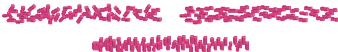
Рис. 3.15. Ориентации цилиндрических частиц: хаотическая, преимущественно вдоль слоя, преимущественно поперек слоя.
