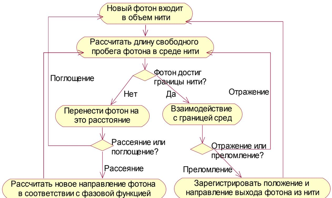
Рис. 2.19. Алгоритм Монте-Карло трассировки лучей в объеме нити.
