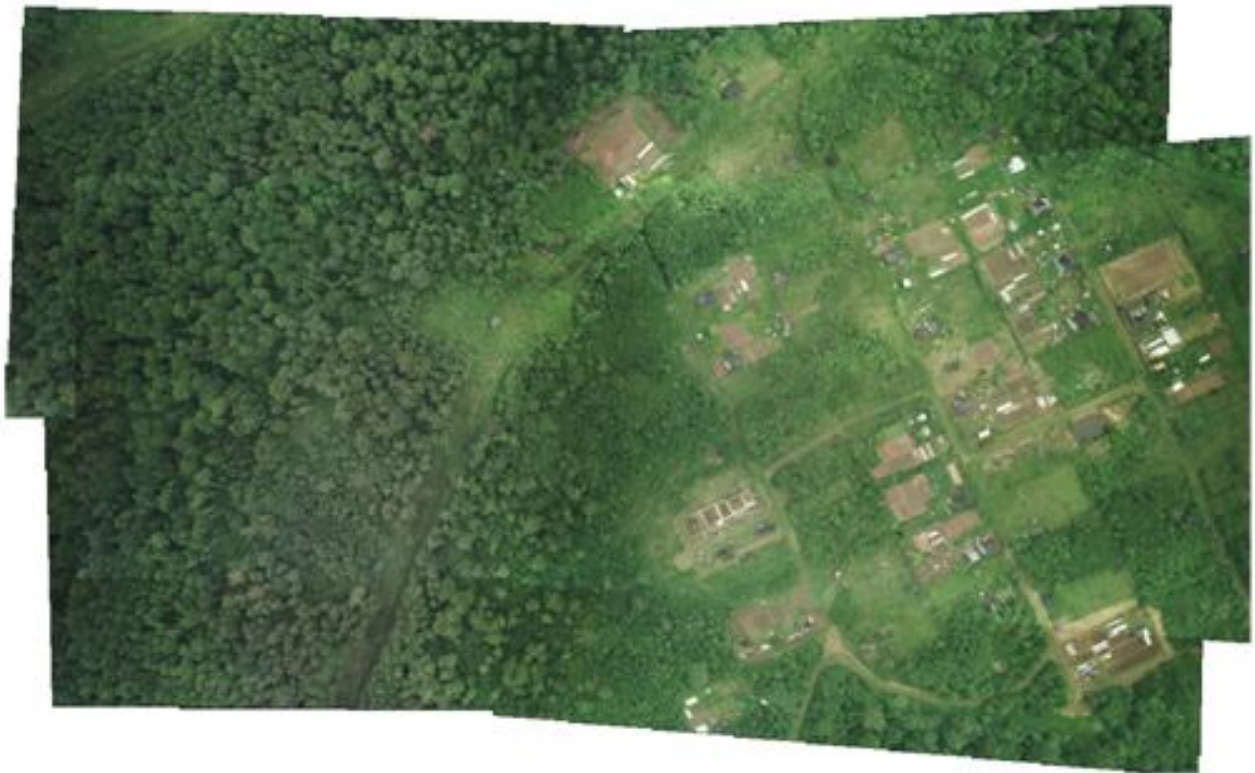
Рис. 14. Пример фотосхемы, построенной по снимкам с БПЛА. Время обработки 12с., 3 пары кадров, размеры фотосхемы ~4200x2600 пикселей.
