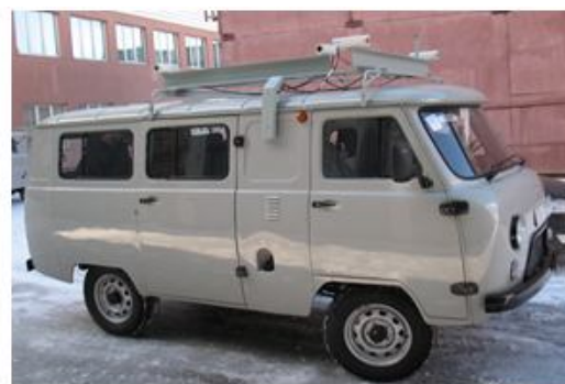
Рис. 4. Расположение камер стереосистем для задачи оперативного картографирования местности на основе системы камер и БИНС. Стереосистемы построены на основе аналоговых камер (720x576 пикселей, 8-bit, 25 Гц).
