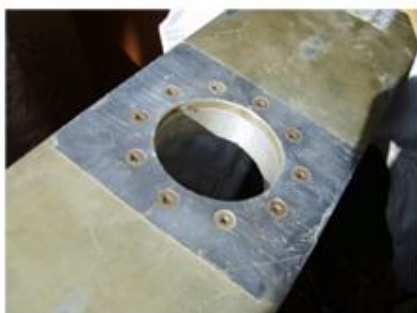
Рис. 5. Примеры изображений, обрабатываемых для решения задачи регистрации трещин в хрупком тензопокрытии.
