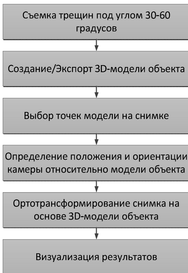
Рис. 16. Блок-схема методики автоматизации процесса регистрации трещин в хрупком тензочувствительном покрытии.
