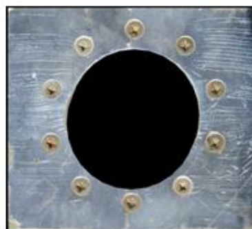
Рис. 5. Примеры изображений, обрабатываемых для решения задачи регистрации трещин в хрупком тензопокрытии.
