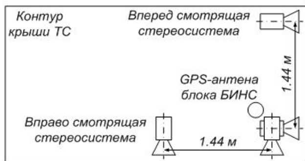
Рис. 4. Расположение камер стереосистем для задачи оперативного картографирования местности на основе системы камер и БИНС. Стереосистемы построены на основе аналоговых камер (720x576 пикселей, 8-bit, 25 Гц).
