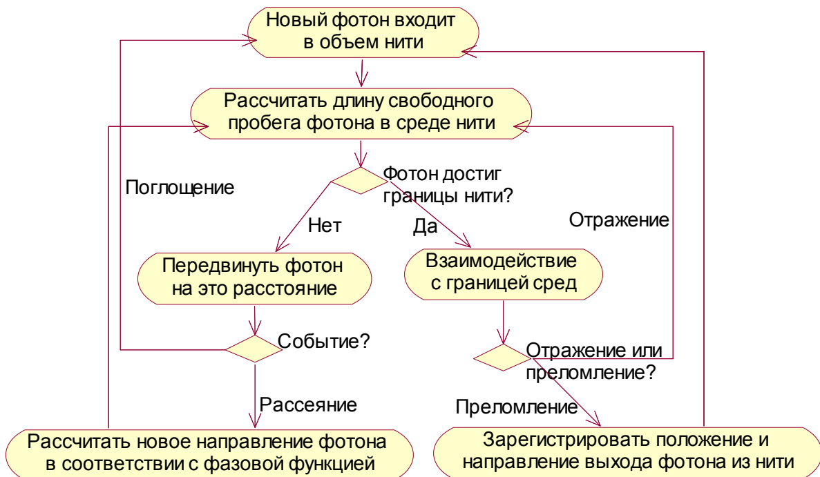
Рис. 4 Алгоритм Монте-Карло трассировки лучей в объеме нити
