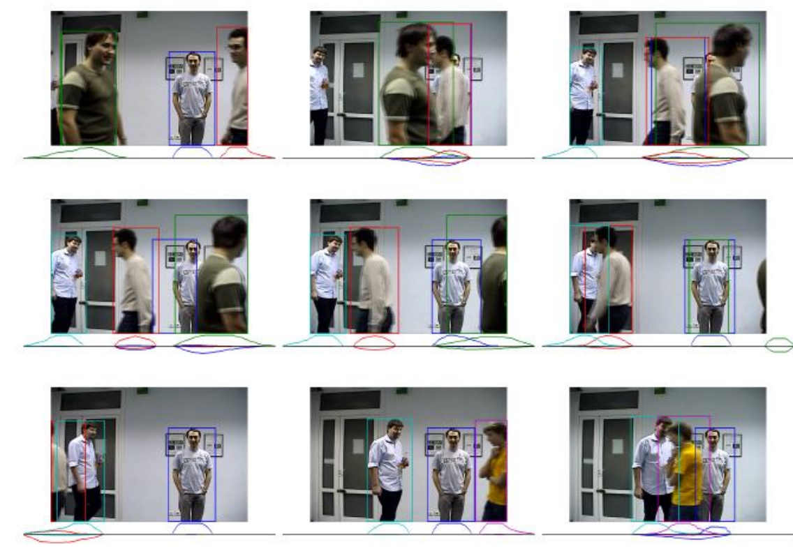
Рисунок 7. Пример работы алгоритма сопровождения людей. Под кадрами показано текущее распределение частиц объекта. Область над линией показывает видимые частицы, область под линией – частицы, которые в данный момент считаются перекрытыми.
