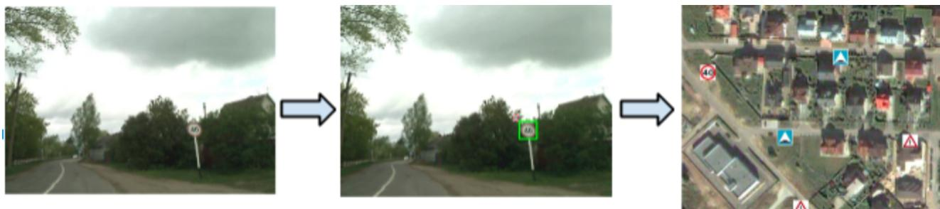
Рисунок 1. Визуализация работы алгоритма автоматического нанесения объектов на карту. На первом этапе происходит выделение и распознавание объектов на нескольких кадрах видеопоследовательности. На втором выделенные объекты сопоставляются между кадрами и производится их локализация на карте.
