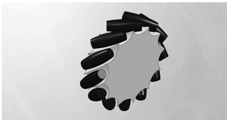
Рис. 41. Изображение модели механум-колеса в программном комплексе САПР SolidWorks
