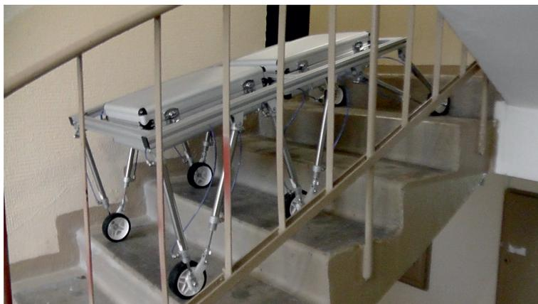
Рис. 61. Колесно-шагающий аппарат на лестнице
