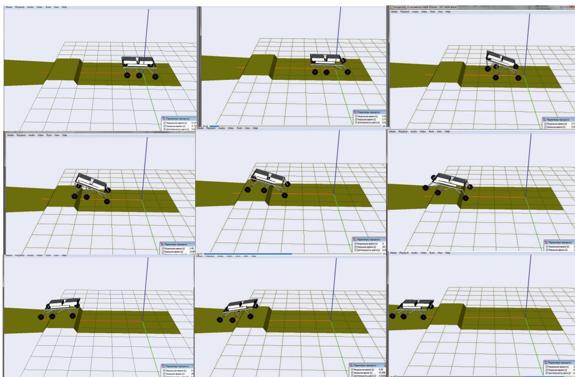
Рис. 60. Кинограмма преодоления препятствия функцией step8
