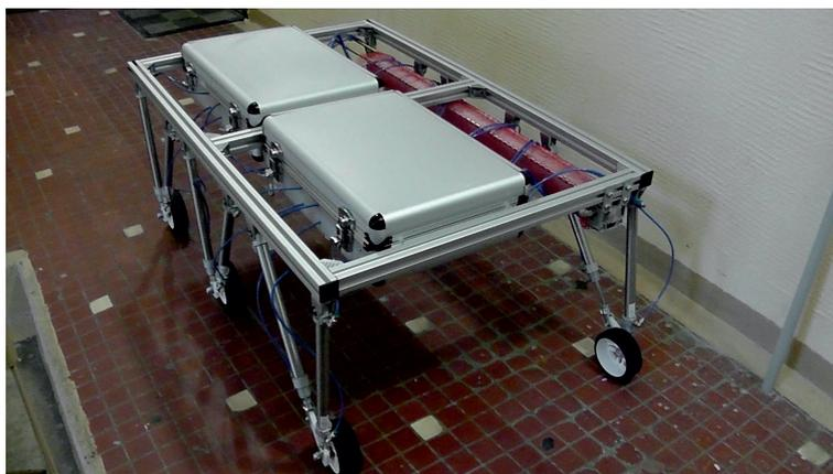
Рис. 54. Версия шестиколесного робота с пассивными колесами
