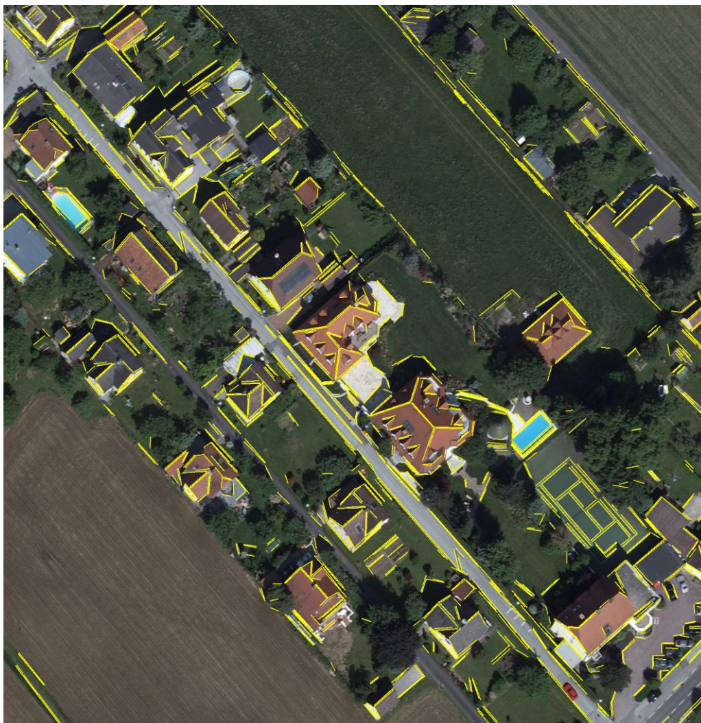
Рис. 10. Отрезки, обнаруженные методом EDLines.
