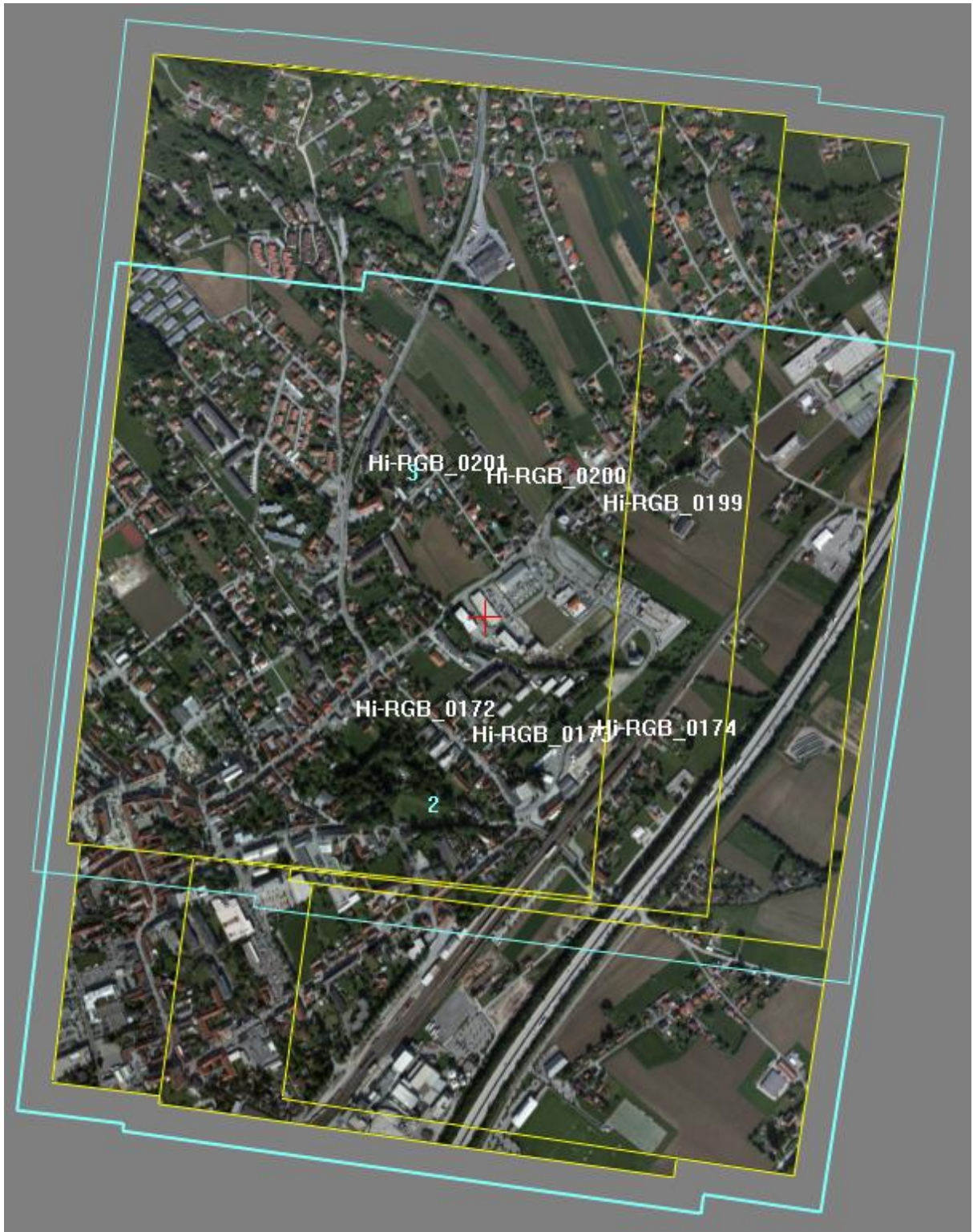
Рис. 25. Тестовые данные проекта UltraCamX со снимками, разложенными по ЭВО.
