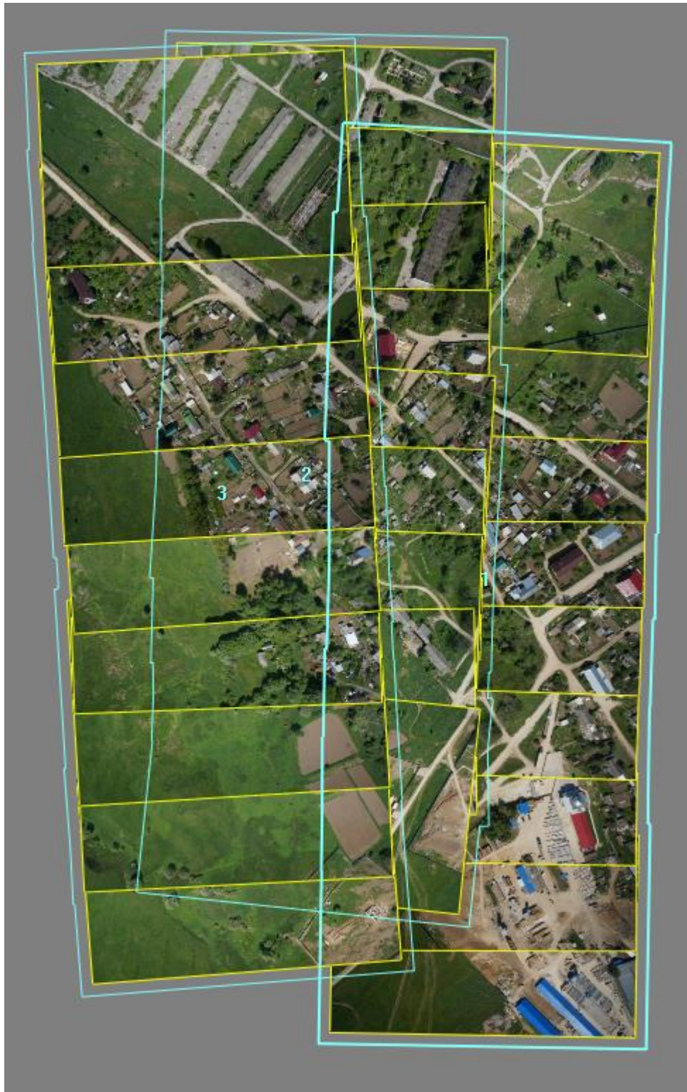
Рис. 27. Тестовые данные проекта UAS_MINI со снимками, разложенными по ЭВО.
