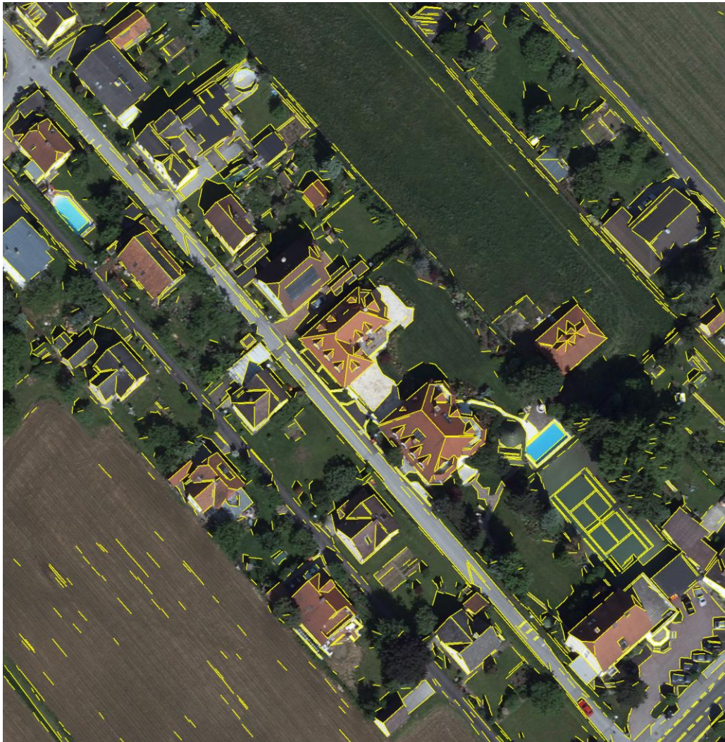
Рис. 9. Отрезки, обнаруженные методом LSD.
