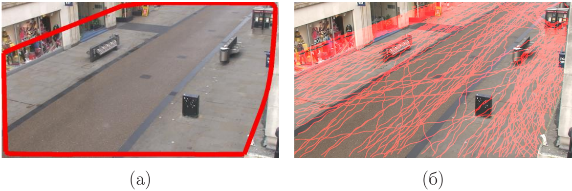
Рисунок 4.5 — Поиск областей входа в сцену. (а) найденная область входа в сцену; (б) визуализация траекторий экспертной разметки
