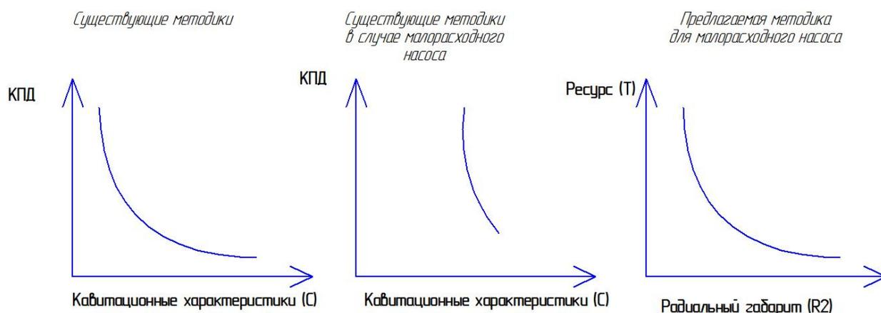
Рисунок 2.1 – Сравнительный анализ различных методик выбора частоты вращения ротора насоса
