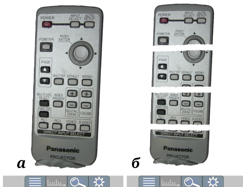
Рис. 11. Трёхмерная модель, состоящая из 4 фрагментов в виде, отображаемом в системе SciVi (а), и с искусственно добавленным расстоянием между фрагментами (б)
