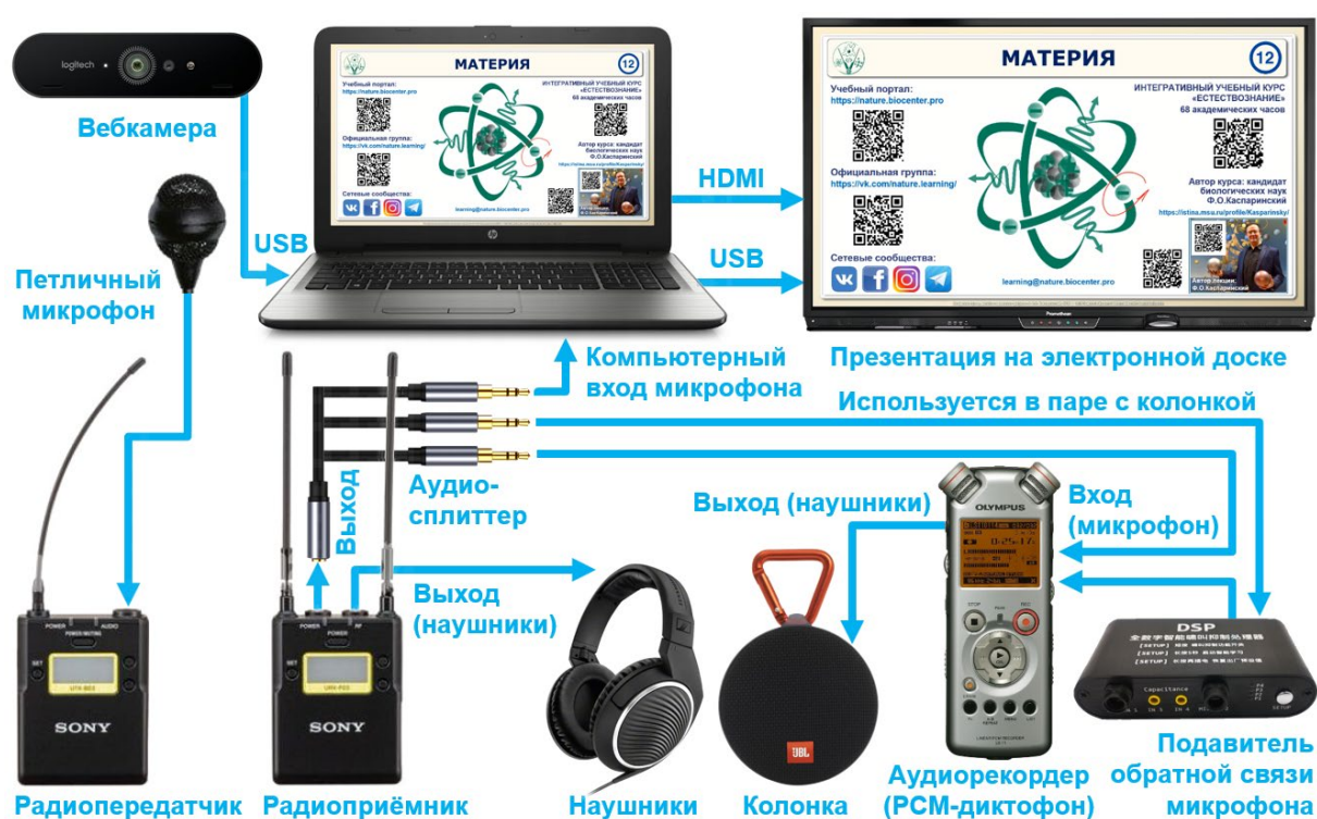
Рис. 2. Схема подключения звукового оборудования для компьютерной записи видеолекций в аудитории
