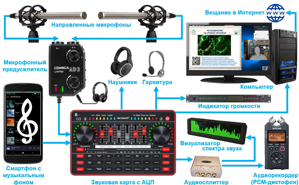
Рис. 6. Схема подключения звукового оборудования для онлайн-вещания
